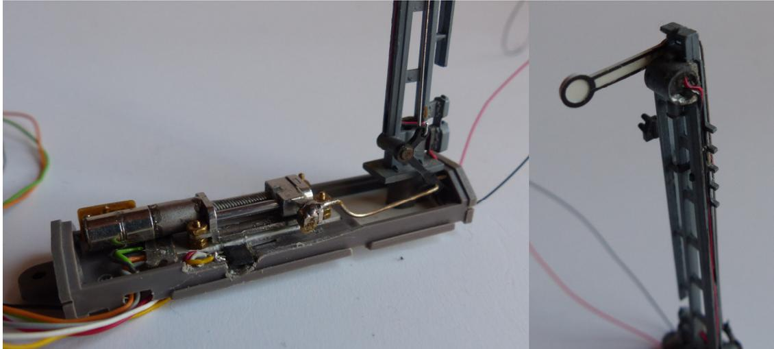
Bei dem Signal wurde der Magnetantrieb entfernt und der Motor auf eine Bodenplatte geschraubt. Zusätzlich hat Michael noch einen Hallsensor eingebaut, der aber nicht gebraucht wird. Das Lampengehäuse hat er gekürzt und die Lampe durch eine kleine Diode ersetzt. Damit wird das Signal zwar immer noch nicht originalgetreu, aber doch schon schöner.
