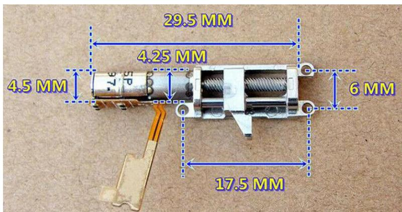
Die äußeren ca. Maße kann man der obigen Zeichnung entnehmen. Der Schlitten bewegt sich von Anschlag zu Anschlag um ca. 12 mm. Die Betriebsspannung soll 5 V sein. Stromaufnahme ca. 70mA.
