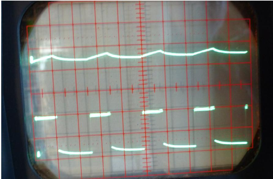
Unten das STEP-Signal zwischen ca. 0,3 und 4 V, oben das ENA-Signal, das zwischen ca. 0,9 und 1,2 V schwankt. Die Low-Zeit ist etwas größer gewählt, damit sich der Kondensator während der High-Zeit nicht zu sehr aufladen kann.
