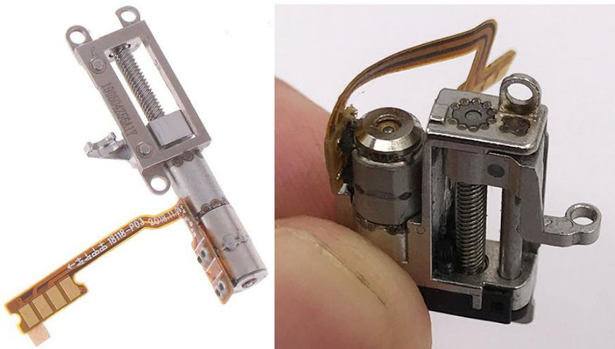
Man findet im Internet eine große Anzahl kleiner Schrittmotoren, wie die oben abgebildeten. Wir hatten einen Motor des linken Typs zur Verfügung. Der rechte hat den Motor neben dem Schlitten. Damit ist er kürzer aber auch breiter. Interessant ist bei diesem Modell, dass es diesen auch mit einer geschlossenen Öse am Schlitten gibt, was vielleicht die Montage eines beweglichen Teils vereinfacht. Dieses Modell ist aber ca. doppelt so teuer wie der längliche Typ.
